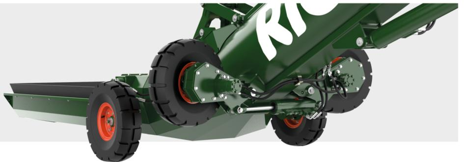
*Dos ruedas motrices de accionamiento hidráulico, montadas sobre un balancín variable en altura, descienden al momento de elevar las ruedas laterales de la batea.*
