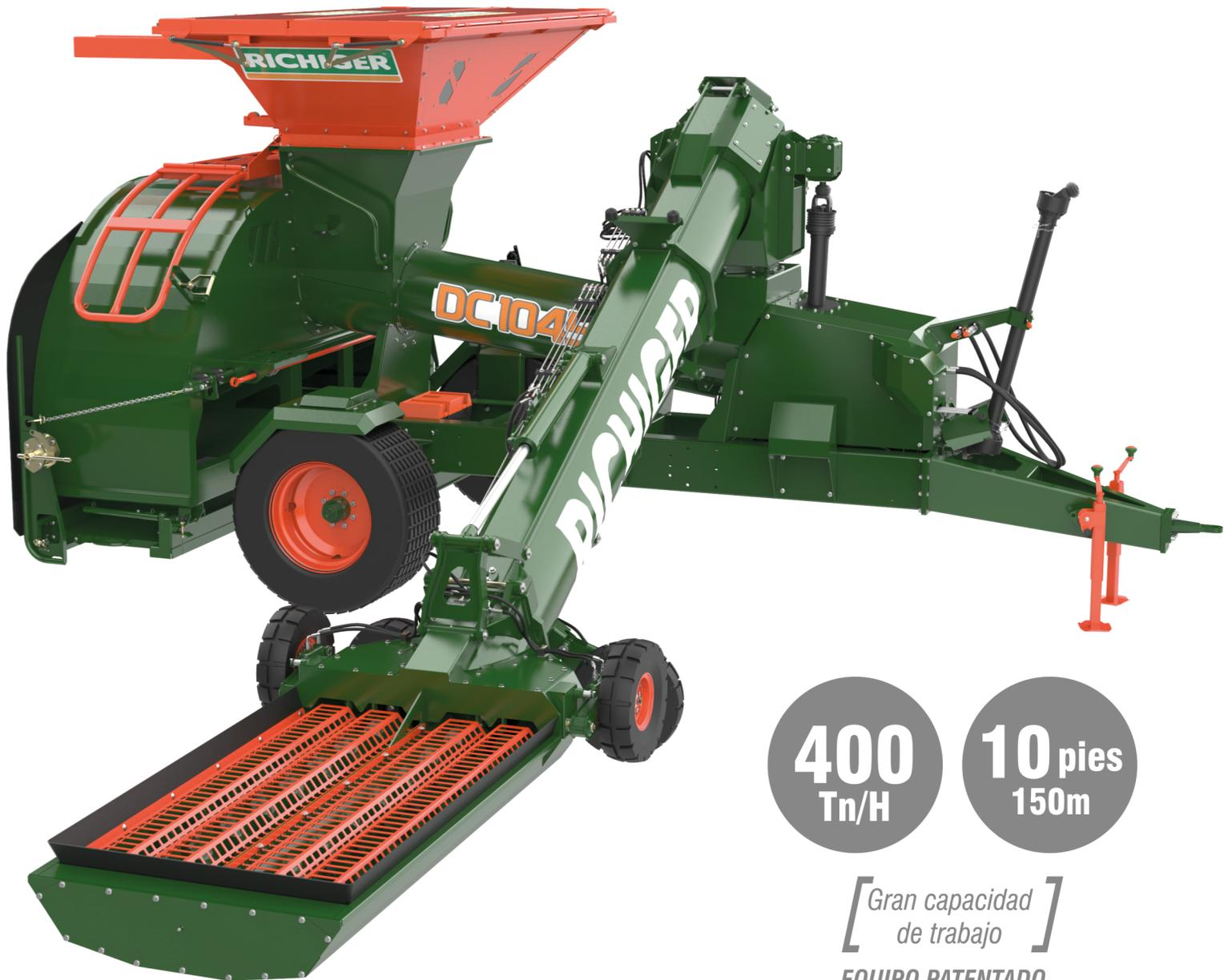
*Embolsadora de granos con sistema de auto-alimentación desde camiones o acoplados tipo tolva (full trailer) con boquilla inferior, lateral o trasera, simplificando toda la logística de manejo del grano con una mayor capacidad de trabajo*
