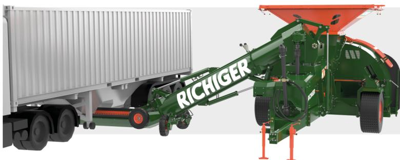
Una vez posicionado el camión, el sistema de descarga se despliega de modo tal que la batea desliza transversal al eje de la máquina y se posiciona justo por debajo de la boquilla del camión permitiendo el proceso de trasvase.
