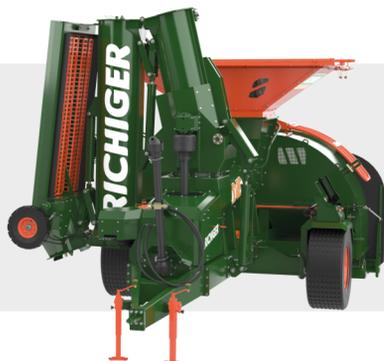
Máquina en posición de transporte con la bolsa ya colocada. En ésta posición permite recepcionar el grano a través de la tolva alimentado por un autodescargable. En ésta situación el accionamiento del sistema de descarga se desacopla.
