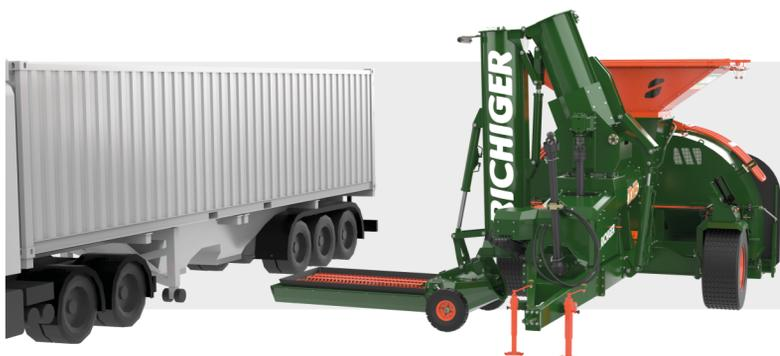
Si se desea trabajar con el sistema de descarga, el primer movimiento a realizar es bajar la batea hasta posicionarla paralela al piso. A continuación ingresa el camión próximo a la batea.
